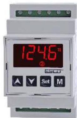
verbautes Steuermodul / Temperaturregler
